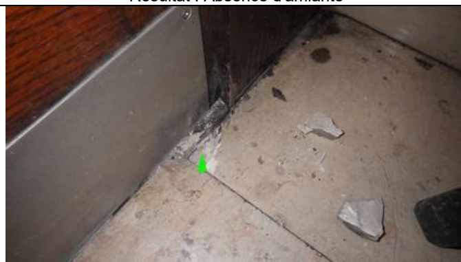
Matériaux : ZPSO-005 – Prélèvement P005 Description : Chape maigre (compacte grise) sous marbre Localisation : 82-84, rue des Pyrénées 75020 PARIS Rez de chaussée – Accès Hall d'entrée – Sol Résultat : Absence d'amiante
